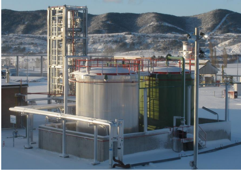
Ilustración 38: Columna de regeneración de metanol en Serrablo.
