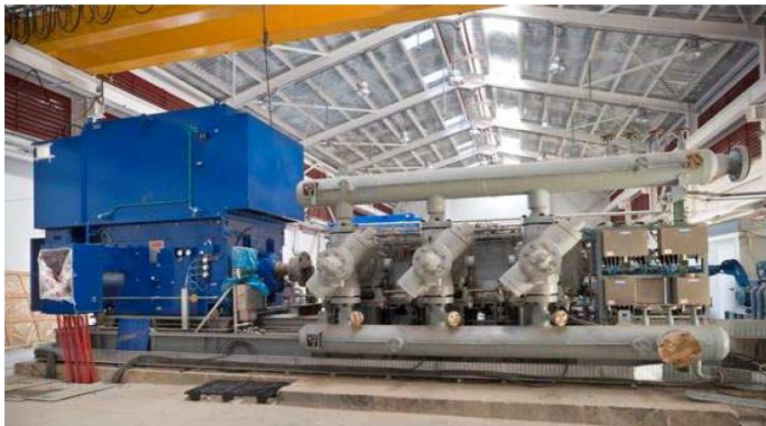
Ilustración 35: Compresor eléctrico alternativo en Yela.
