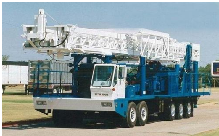
Ilustración 22: Torre de Perforación Auto transportable.
