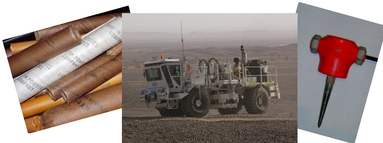
Ilustración 46: Técnicas para la realización de sísmicas: explosivos (Izquierda), camión vibrador (Centro), geófono (Derecha).
