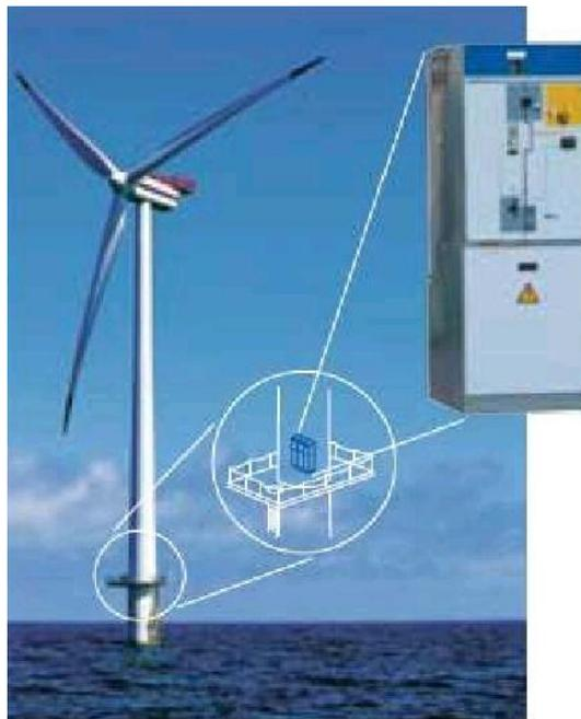
Figura 2.13. Disposición de las celdas en un aerogenerador.
