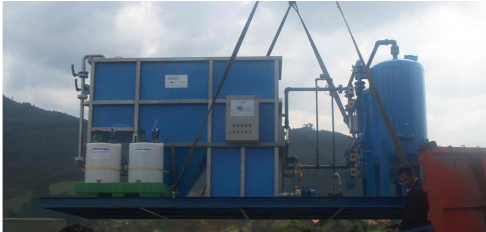
Ilustración 2.13. Ejemplo de potabilizadora transportable
