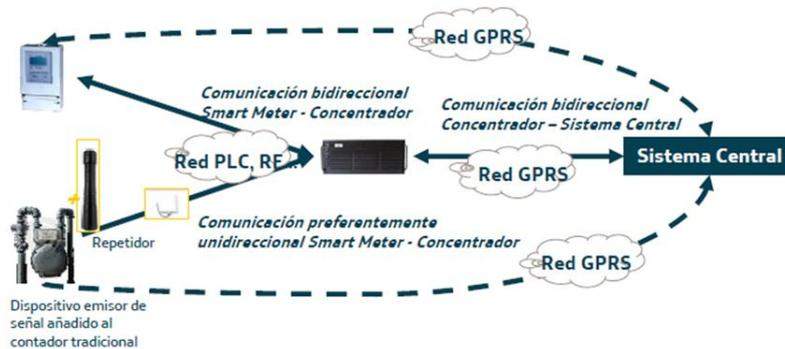
Ilustración 19: M2M para sistemas de contadores eléctricos
