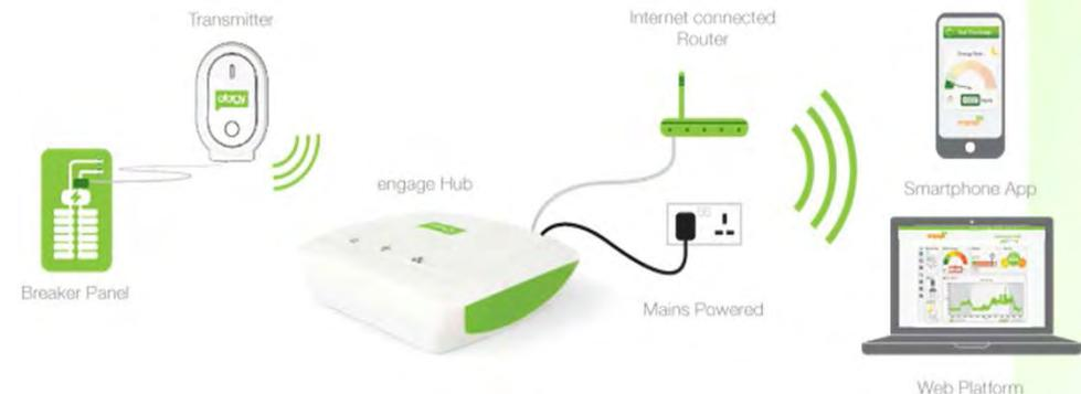
Figura 15. Esquema de funcionamiento del sistema Efergy.
