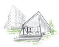
Concienciación en la sostenibilidad, pensando en el reciclaje, recuperación y reutilización de componentes, por lo que el diseño estará basado en el principio de superposición de capas y sistemas constructivos desmontables.
