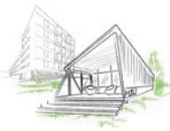
3. Pórticos de perfiles tubulares de acero galvanizado con uniones atornilladas y forjado en seco de chapa grecada de acero galvanizado y tablero hidrófugo.
