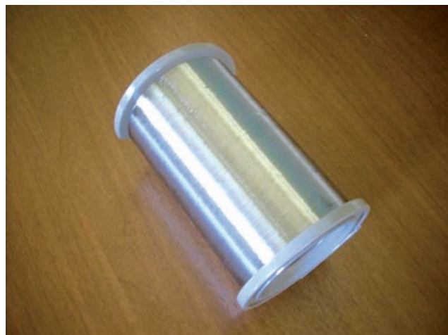
FIGURA 26 Filamento de acero inoxidable del núcleo del hilo calefactor
