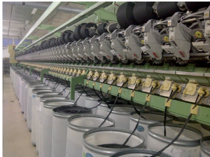
FIGURA 36 Mecanismo formador del hilo en la máquina open-end
