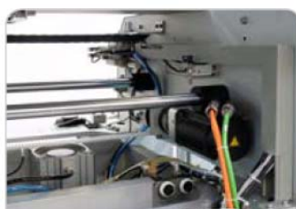
Motor brushless para transporte de bandejas
