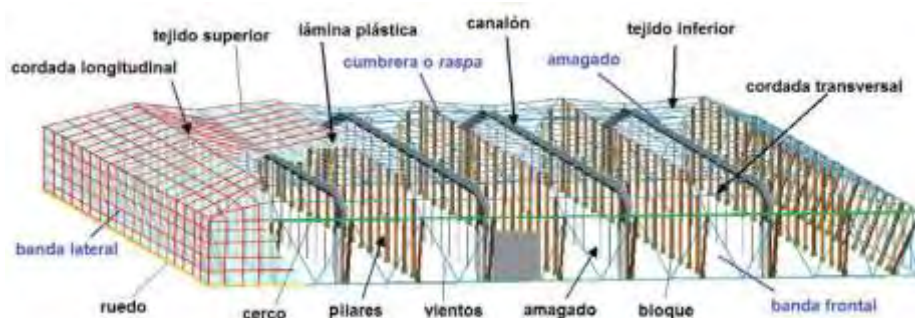
Gráfico 5.- Estructura de un invernadero tipo Almería.
