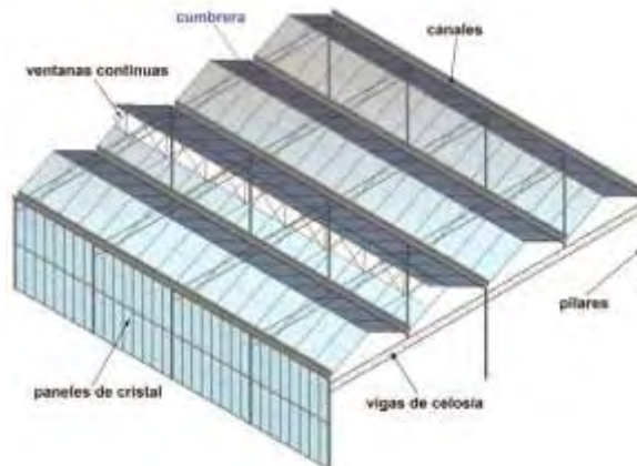
Gráfico 201.- Estructura de un invernadero de cristal tipo venlo.
