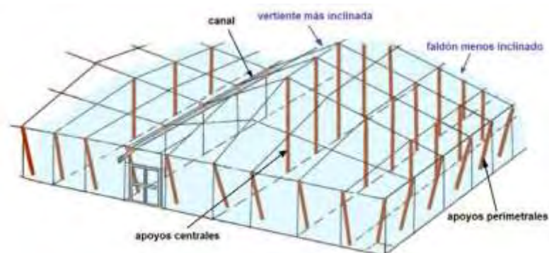
Gráfico 6.- Estructura de un invernadero asimétrico.
