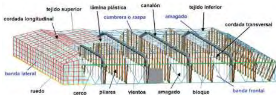
Gráfico 198.- Estructura de un invernadero tipo Almería.
