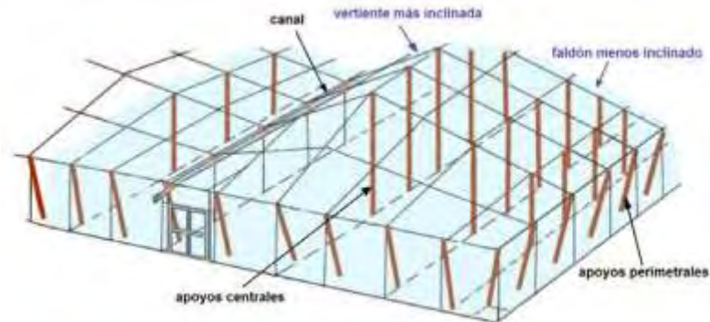
Gráfico 164.- Estructura de un invernadero asimétrico.
