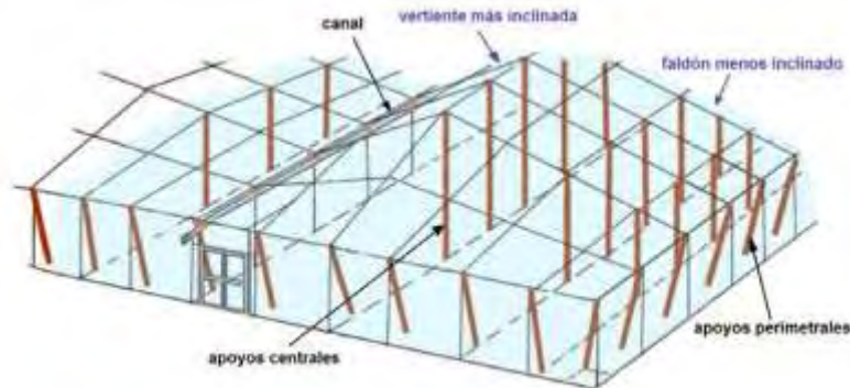
Gráfico 199.- Estructura de un invernadero asimétrico.
