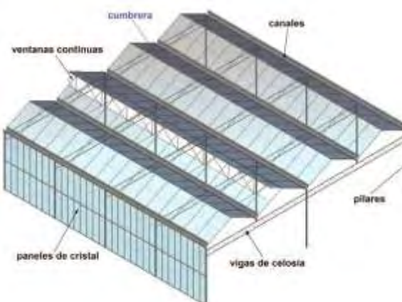
Gráfico 8.- Estructura de un invernadero de cristal tipo venlo.
