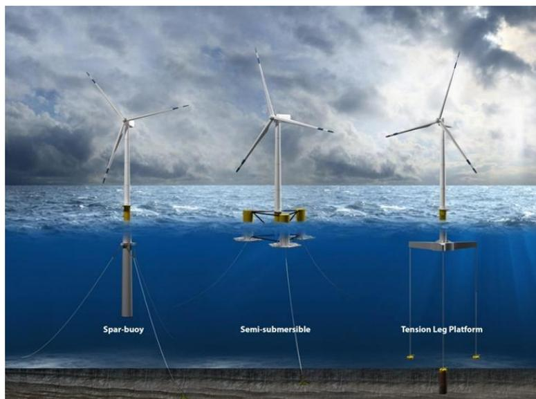
Ilustración 32. Sistemas de anclaje flotantes
