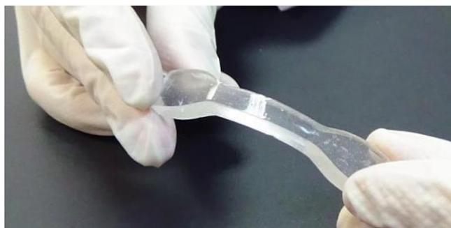
Después de 24 horas, la superficie tratada con el nuevo material vuelve al estado en el que se encontraba antes de producirse el daño. El nuevo material, una resina transparente, tiene un gran potencial de aplicación en el sector médico, ya que, además de ser inocuo, es efectivo incluso en contacto con líquidos, una característica muy destacada para una aplicación eficaz en entornos sanguíneos y otros fluidos corporales como catéteres, corazones artificiales e incluso cubiertas de prótesis.
